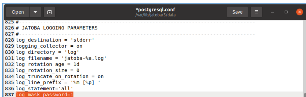
Рисунок 3.3 – Параметры postgresql.conf обязательные для маскирования паролей
